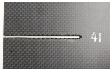
ダブルワブリング加工法（表面）
