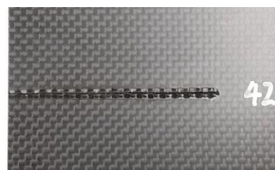
従来の単純パスでの加工法（表面）
